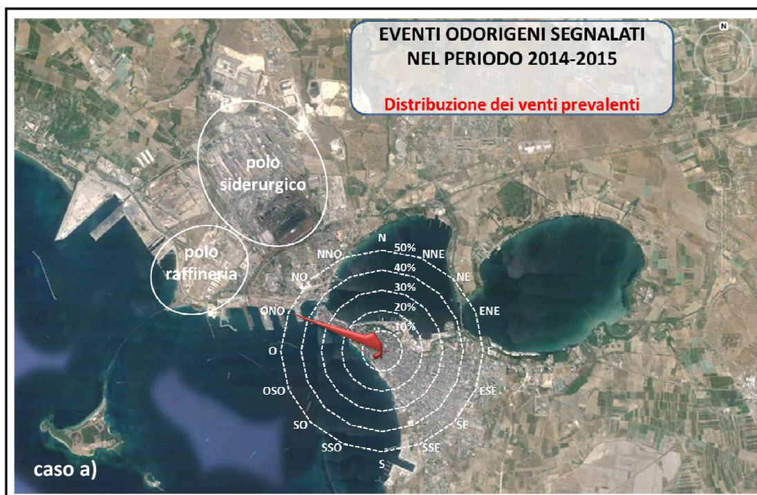
Figura 11.a - Distribuzione dei venti prevalenti per gli eventi odorigeni registrati, con indicazione dell'ubicazione della centralina meteorologica (📍)
